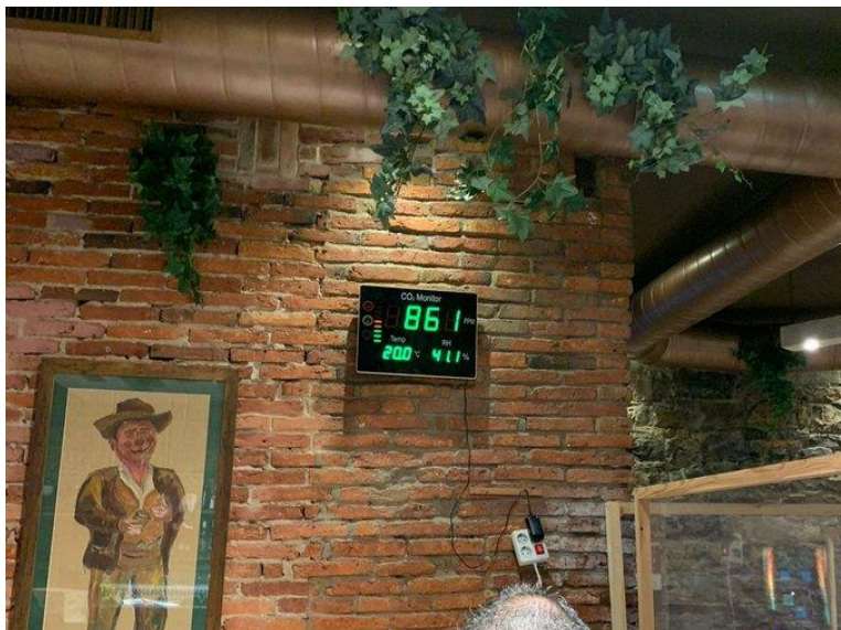
Monitor de pared de medidor de CO 2 aplicado a la hostelería. Fuente @dafragrup
